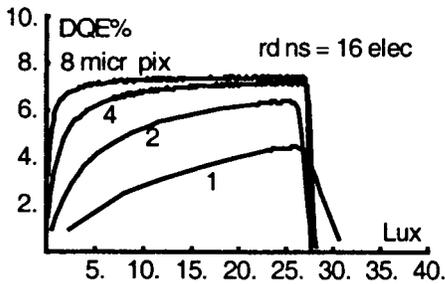
Figure 2. DQE-exposure curves: 16 electrons rms read-noise.
