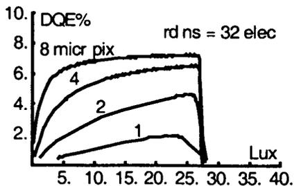
Figure 3. DQE-exposure curves: 32 electrons rms read-noise.
